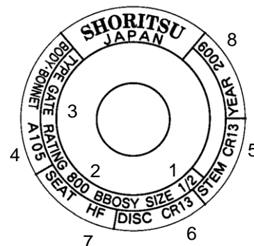
弁箱材質 A105 の場合の例 輸出用銘板（仕切弁及び玉形弁） NAME PLATE FOR EXPORT (GATE VALVE AND GLOBE VALVE)
